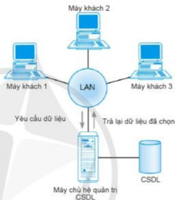
Hình 3. Mô hình Khách – Chủ 2 tầng của CSDL tập trung
